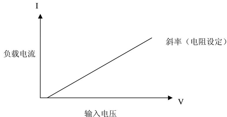
智能恒电阻模式，可自动判别并适应被测电源的工作方式，使恒电阻模式的应用功能更完善。无论被测电源是电压源 (CV) 还是电流源 (CC)，即便是在两种方式间转换，或者是一些具有限流限功率保护的电源，智能恒阻模式都能正常工作。
