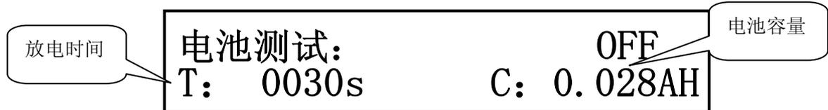
提示：放电测试过程中，也可按【ENT】键切换显示，从而实时观察放电时间及容量。
