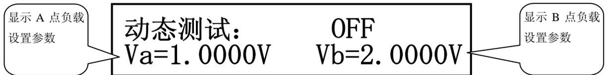
在其它负载模式下，按【SHIFT】+【TRAN】键进入动态测试模式，按【ON/OFF】启动或停止动态测试。
