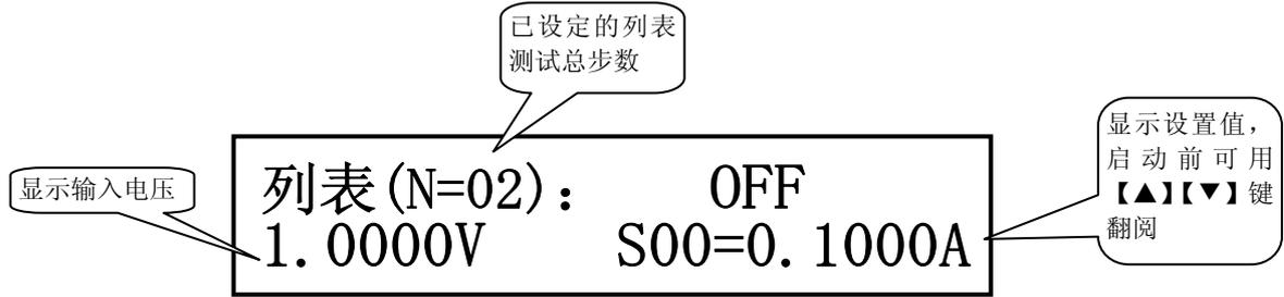
启动列表测试前应首先对相关参数进行设置，按【SHIFT】+【S-LIST】进入列表参数设定菜单。详细请参阅 3.4.5 列表测试设置菜单。
