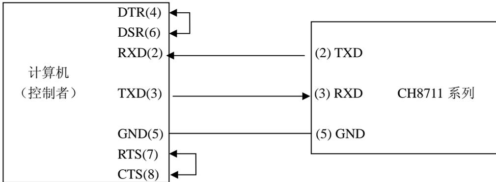
由上图可以看到，本仪器的引脚定义与 IMB AT 兼容机使用的 9 芯连接器串行接口引脚定义有所不同。用户可使用双芯屏蔽线按图示自行制做三线连接电缆（长度应小于 1.5m）或向本公司购买串行接口电缆线。
